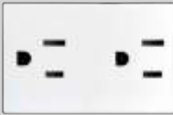
333721 Tomacorriente Americano Duplex 15A 127V~ 2P+T
